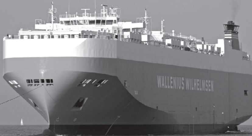
Talia - samochodowiec o długości prawie 200 m, szerokości 32 m i nośności 21 tys. ton, zabierający na pokład ok. 6400 samochodów.
