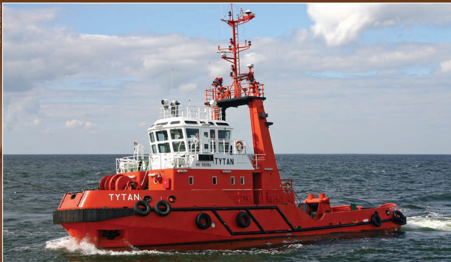
Tytan (IMO 9101194, sygnał wywoławczy SPG2541); uciąg na palu 48 T.
