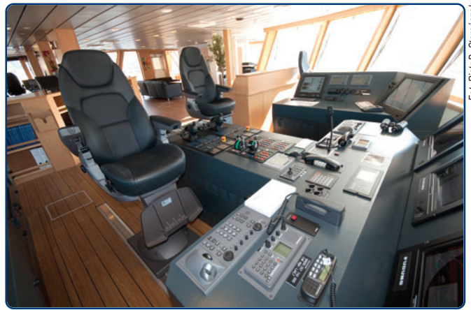
Główne stanowisko nawigacyjne w sterówce Normand Pacific (w przedniej części).
