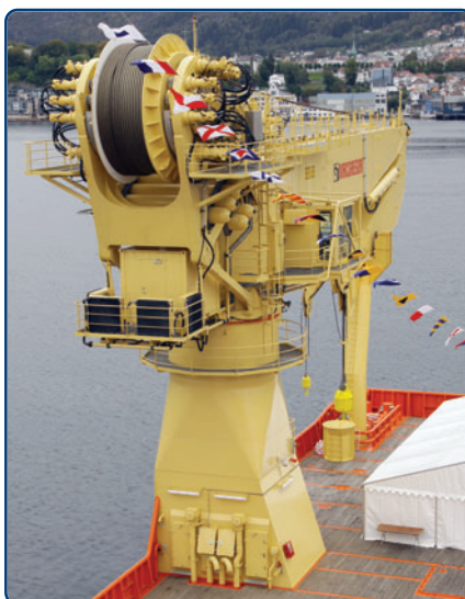
Przy prawej burcie umiejscowiono potężny żuraw pokładowy.
