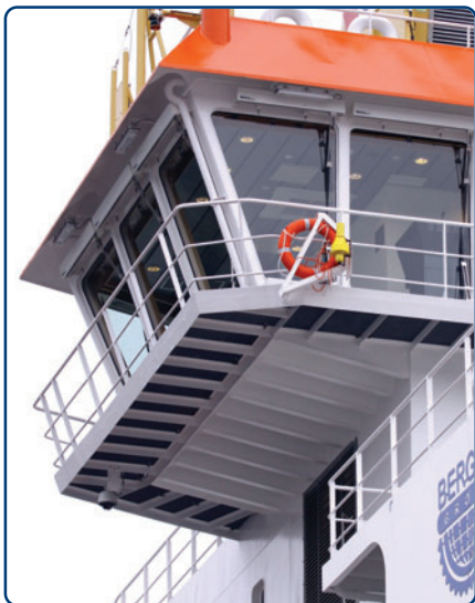
Lewe skrzydło pomostu nawigacyjnego (z pomieszczeniem zapasowej sterowni DP).
