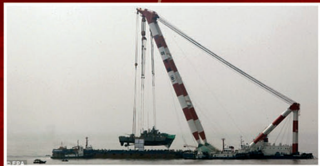
Układanie rufowej części wraku na pokładzie barki.
