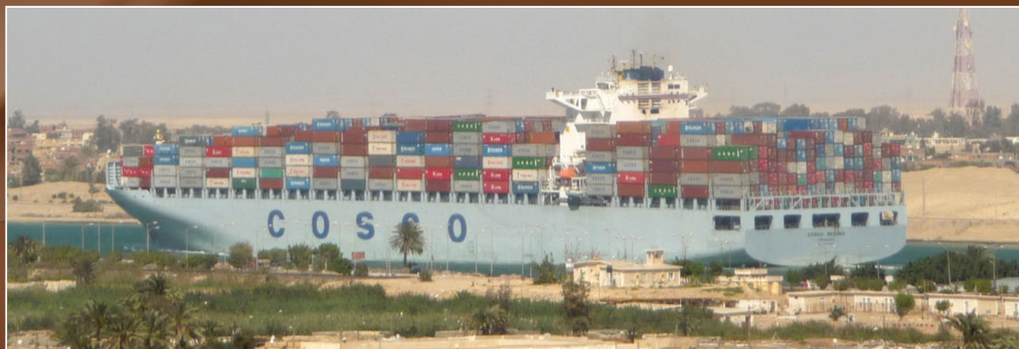
Cosco Beijing - kontenerowiec zbudowany w 2006 r., IMO 9308508, długość 350,56 m, szerokość 42,8 m, prędkość 25,4 węzły, nośność 107 277 t, ładowność 9450 TEU, pływa pod banderą grecką.
