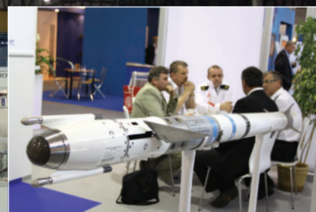
Rolling Airframe Missile - pocisk rakietowy z wirującym kadłubem na stoisku niemieckiej firmy RAM GmbH.
