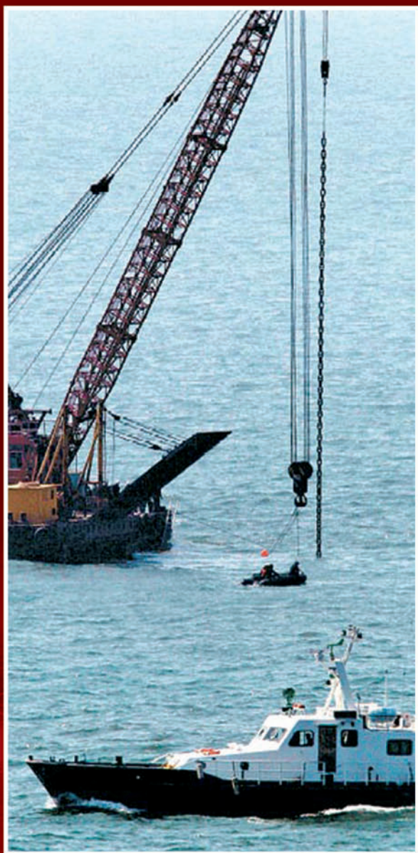
Podnoszenie z dna oddzielonych części wraku.
