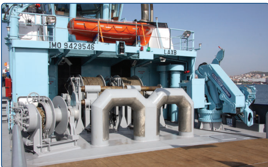
Rufowa wciągarka holownicza (w centrum) oraz podwójna przewłoka holownicza, wciągarka manipulacyjna (po lewej) i żuraw pokładowy (po prawej).
