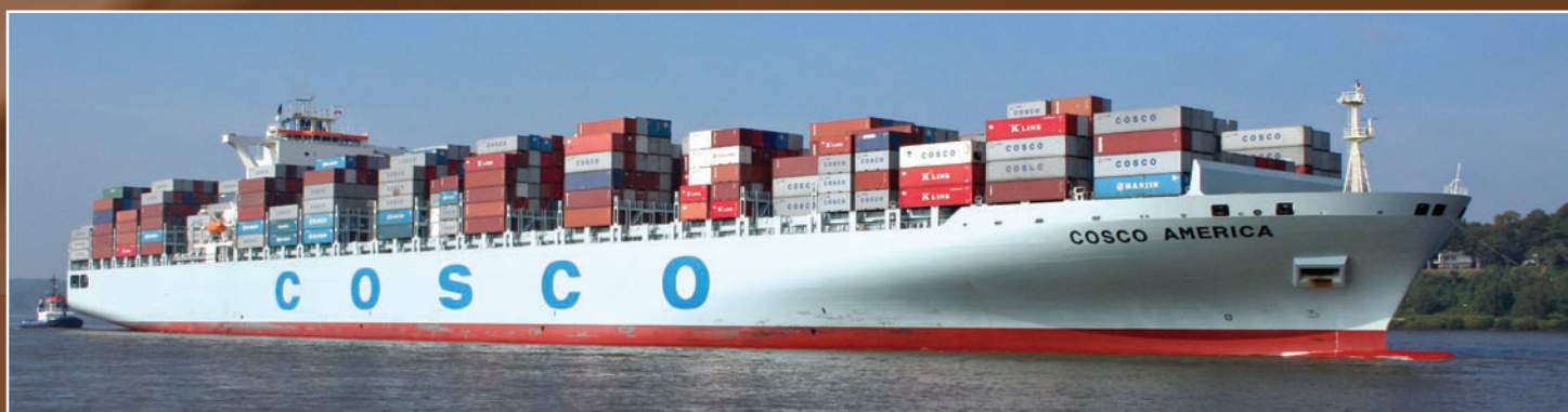
Na koniec jeszcze jeden olbrzym chińskiego armatora - tym razem COSCO, czyli China Ocean Shipping (Group) Co. COSCO America - uchwycony na zdjęciu we wrześniu 2008 roku, gdy COSCO wciąż samo było jego operatorem. Obecnie statek pływa w czarterze u koreańskiego Hanjin Shipping Co. Ltd. pod nazwą Hanjin Alexandria . Jednostka charakteryzuje się długością całkowitą 349,07 m, szerokością 45,60 m, zanurzeniem 14,525 m i wysokością bocznią 27,30 m oraz wypornością 147 723 t, nośnością 109 950 t i GT 114 394. Kontenerowiec o ładowności 10 051 TEU (4876 w ładowniach, 5184 na pokładzie, 800 przylączy dla pojemników chłodzonych) został zbudowany kosztem 127 mln USD w 2008 r. przez stocznnię Hyundai Heavy Industries Co., Ltd. w Ulsan w 2008 roku.
