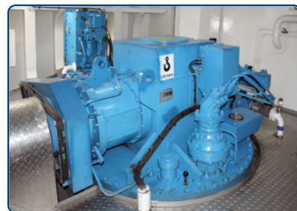
Głowica pędnika azymutalnego z przekładnią kątową.
