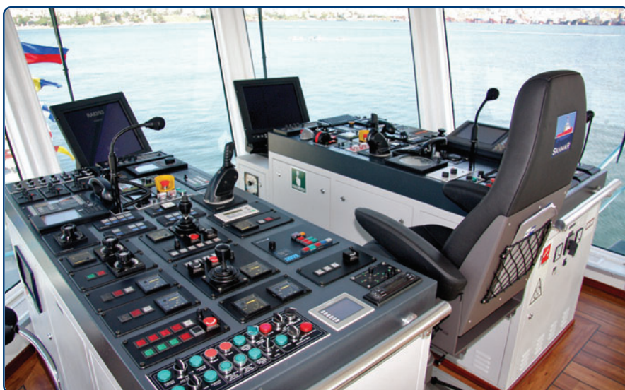
Zasadnicza część sterówki - stanowisko kapitana i panele sterownicze.
