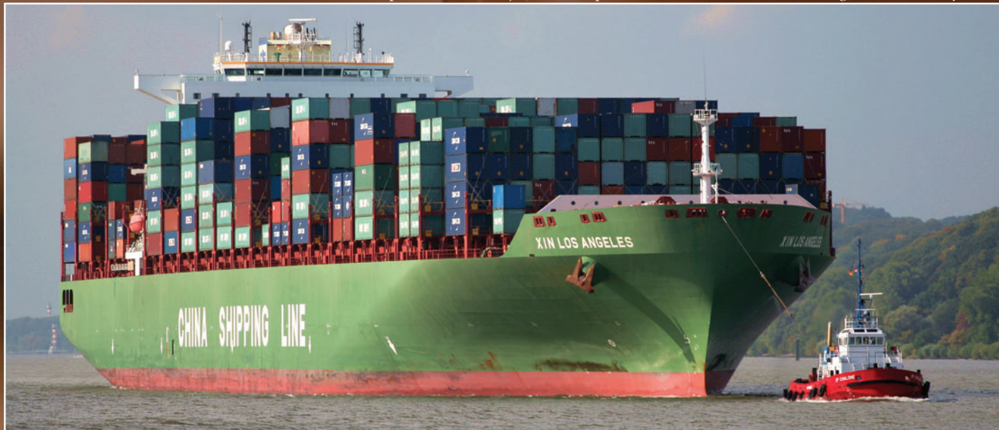
Xin Los Angeles - długi na niemal 337 m pojemnikowiec post-panamax standardowego projektu Samsung 9500 o ładowności 9572 TEU (4666 TEU w ładowniach, 4906 TEU na pokładzie, w tym 700 pojemników chłodzonych), nośności 111 889 t, wyporności 121 920 t i GT 108 069. Operatorem statku zbudowanego w 2006 roku przez stocznnię Samsung Heavy Industries Co., Ltd. w Geoeje, jest China Shipping Container Lines.
