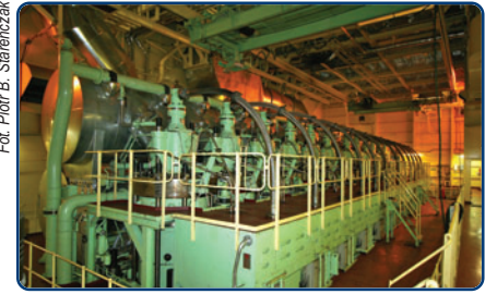
Silnik napędu głównego typu 12RT-flex96C, bez wody i paliwa waży 2010 ton.
