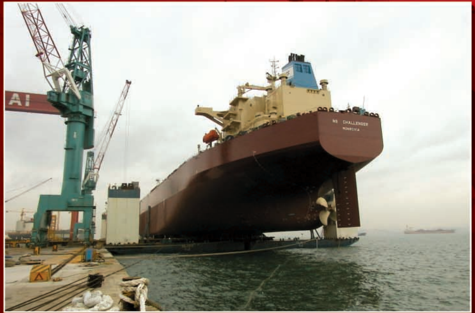
Pełny sukces: NS Challenger wsunięty na ponton wodujący.
