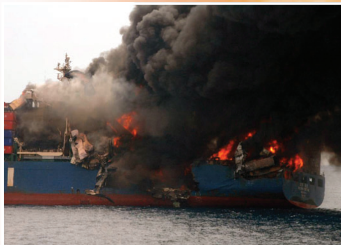
Siła wybuchu poważnie uszkodziła poszycie powyżej linii wodnej.
