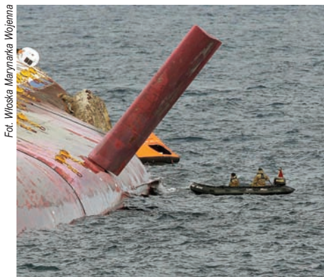
Stabilizator płetwowy lewej burty w pozycji roboczej. Jeżeli był wyłożony tak, jak widać na zdjęciu w chwili uderzenia statku w skały - może to sugerować, że nawigator zorientował się, że statek znalazł się za blisko skalistej wysepki i w momencie uderzenia, był już w trakcie wykonywania ostrego zwrotu w prawo.
