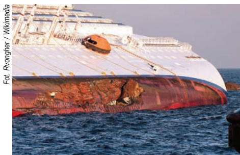
Wielki fragment skały utkwiał w uszkodzonej konstrukcji kadłuba statku.
