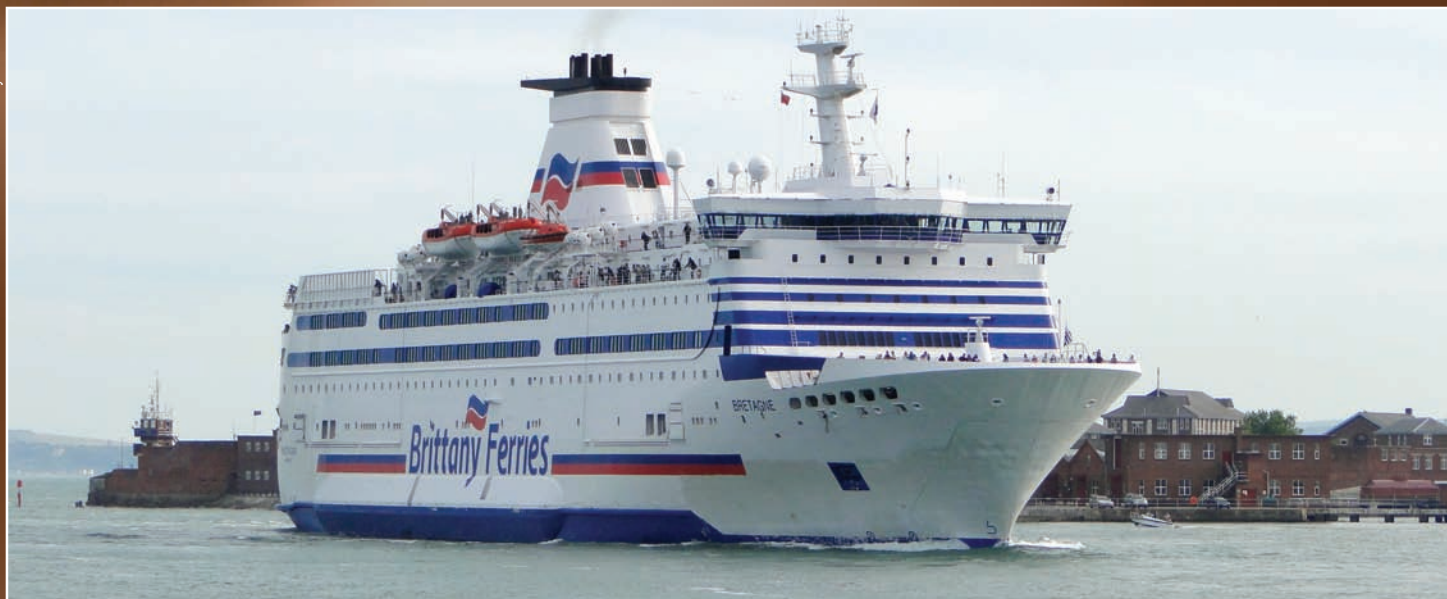
Prom Bretagne obsługuje linię łączącą Portsmouth z St. Molo. Przekazany armatorowi w 1989 roku statek ma 24 534 jednostek pojemności brutto, przy długości 152,8 m i szerokości 26 m. Prędkość podróżna wynosi 21 węzłów. Zabiera on 2056 pasażerów i 580 samochodów. Załoga 130 osób.
