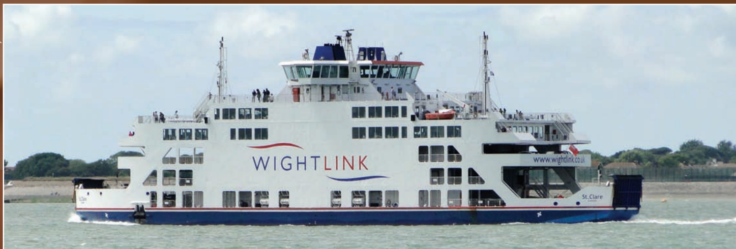
Prom St. Clare (zbudowany w 2001 roku w Gdańskiej Stoczni Remontowej) utrzymuje połączenie między Portsmouth a Fishbourne na wyspie Wright. Prędkość podróżna wynosi 13 węzłów. Przy długości 86 m, szerokości 18 m i zanurzeniu 2,6 m, zabiera o 878 pasażerów i 186 samochodów osobowych na trzech pokładach.
