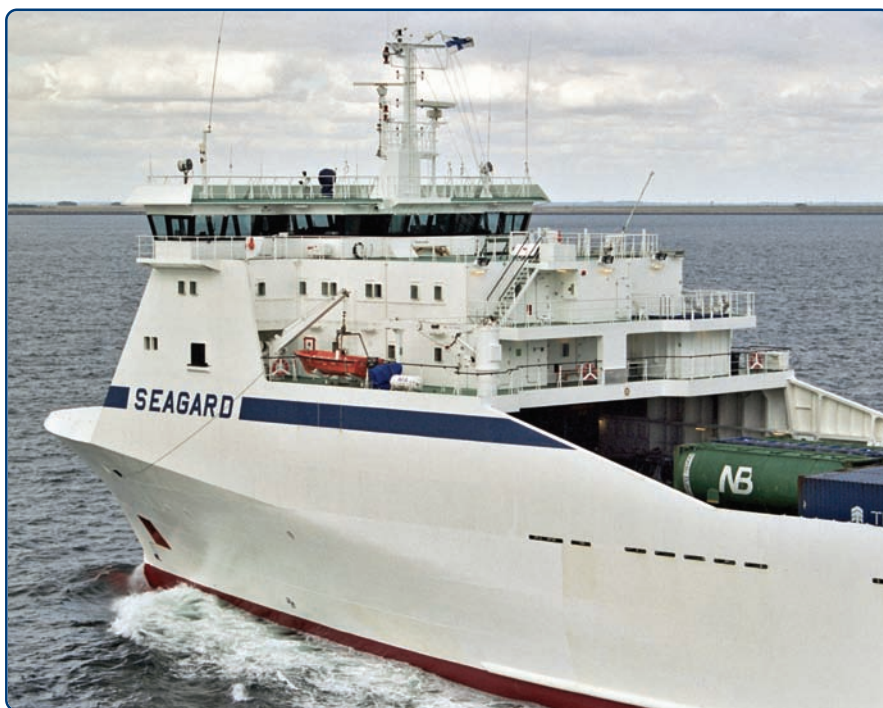
Seagard - pewna niewielka część przestrzeni ładunkowej na pokładzie górnym przykryta jest przez nadbudówkę.
