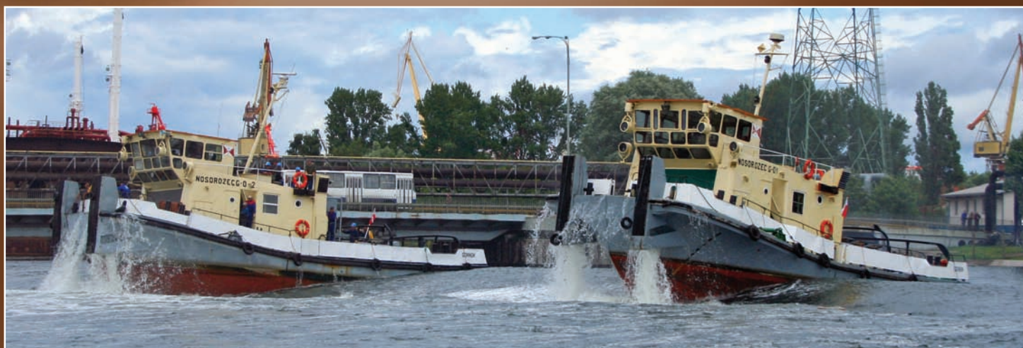
Nosorożec G-01 i Nosorożec G-02 - pchacze (typu Nosorożec, zbudowane w 1970 r. w Kozielskiej Stoczni Rzecznej (n-ry budowy 112), długość 21m, szerokość 8,6 m, zanurzenie 2m), używane są przez armatora - Żegluga HTS Sp. z o.o. z Gdańska - do wszelkich prac holowniczych i jako pchacze w porcie, często wykorzystywane są do obsługi doków i pontono-barek, przez które woduje się kadłuby i którymi przewozi się między zakładami montażu i stoczniami bloki i sekcje oraz całe kadłuby statków; pchacze te obsługują też często wodowania w trójmiejskich stoczniach, głównie w Stoczni Północnej SA, „Japiąc” i zatrzymując statki na kanale portowym w chwilę po wodowaniu bocznym.
