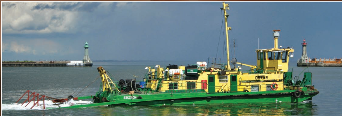
Oskar - pchacz (typu Koziorożec, zbudowany w 1983 w Stoczni Odra, Szczecin (nr budowy B598/12), długość 20,27 m, szerokość 8,62 m, zanurzenie 0,83 m, klasyfikowany w materiałach informacyjnych armatora - Przedsiębiorstwo Robót Czerpalnych i Podwodnych z Gdańska - jako „holownik”, przystosowany do pomocniczych prac w pogłębiarstwie (przez montaż ramy zawieszanej po obu stronach kadłuba na dziobie i opuszczanej pod rufą - urządzenia do wyrównywania dna po pracy pogłębiarek przed układaniem „materacy” stabilizujących dno basenu lub kanału portowego).
