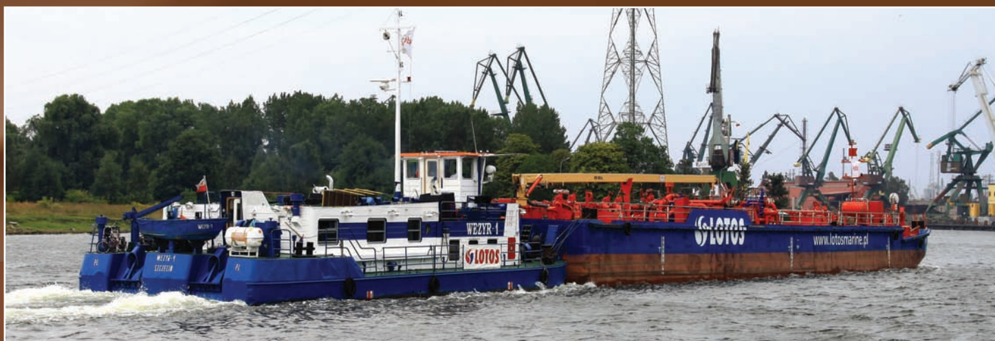
Wezyr-1 - to pchacz (typu Bawół-I, ze względu na nazwy własne serii jednostek, czasami określane jako należący do typu Muflon, zbudowany w 1983 roku przez Wrocławską Stocznię Rzeczną, o długości 22,57 m, szerokości 8,98 m i zanurzeniu maks. 1,18 m) należący do armatora Project Żegluga ze Szczecina, a eksploatowany ostatnio (w czarterze) przez gdański koncern naftowy Lotos, wraz z barką-ziornikowcem, jako zespół bunkrowy (zaopatrujący statki w paliwo). Pchacz Wezyr-1 nosi na kominach znak armatorski niemieckiej firmy Fairplay (znanej głównie z usług holowniczych portowych i morskich), do której należy Project Żegluga.
