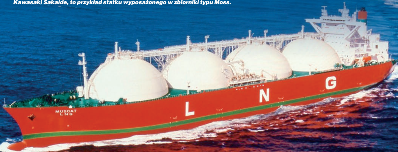
Muscat LNG, gazowiec o poj. 150 tys. m sześć., zbudowany w japońskiej stoczni Kawasaki Sakaide, to przykład statku wyposażonego w zbiorniki typu Moss.
