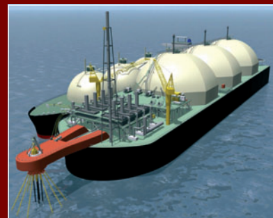
Tankowiec LNG zacumowany burtą w burtę do stacji FSRU. Ilustracja z Projektu Cabrillo Port z 2004 roku, dotyczącego budowy jednostki FSRU w hrabstwie Ventura w Kalifornii. W USA na skutek protestów ludności przeciwko budowie lądowych terminali LNG coraz częściej rozpatruje się projekty takich stacji morskich.
