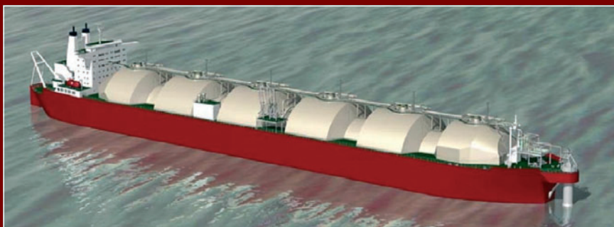
Stacja FSRU powstanie z przebudowanego statku ze zbiornikami kulistymi w projekcie realizowanym w stoczni Keppel'a – wizualizacja i plan ogólny.
