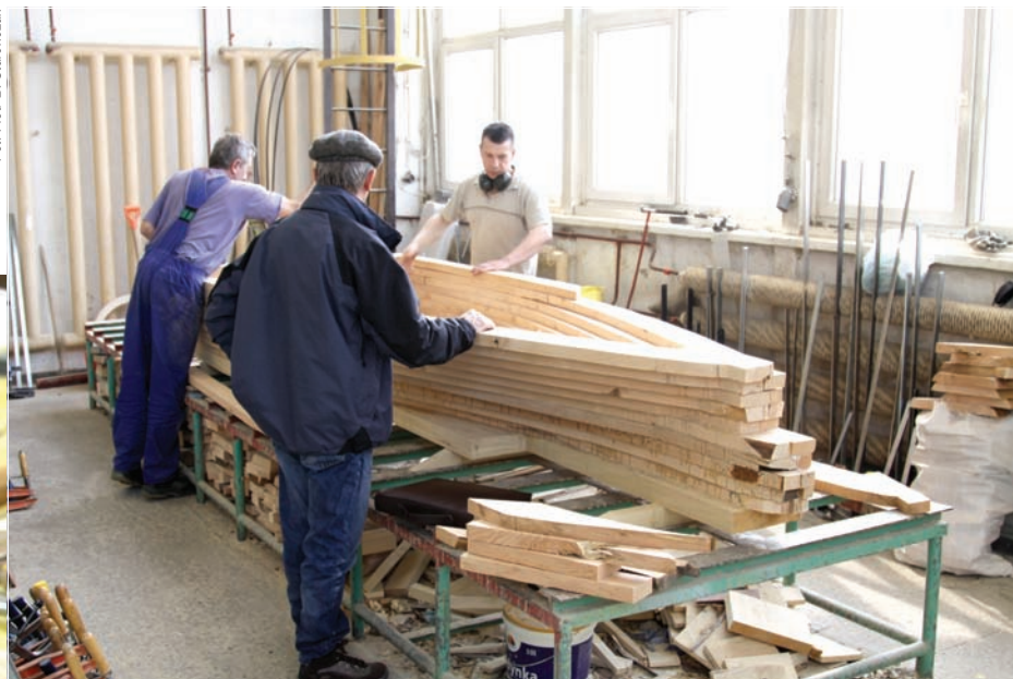
Prace przy budowie modeli i ich przygotowaniu do badań w basenie holowniczym.
