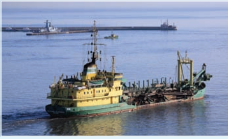
Pogłębiarka ssąca nasiębierna ze smokiem wleczonym Inż. Stanisław Łęgowski gdańskiego Przedsiębiorstwa Robót Czerpalnych (PRS) wychodzi z portu Gdynia z urobkiem, udając się na kłapawisko.
