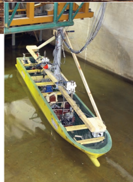
Badania właściwości manewrowych statku na mniejszym basenie modelowym CTO.
