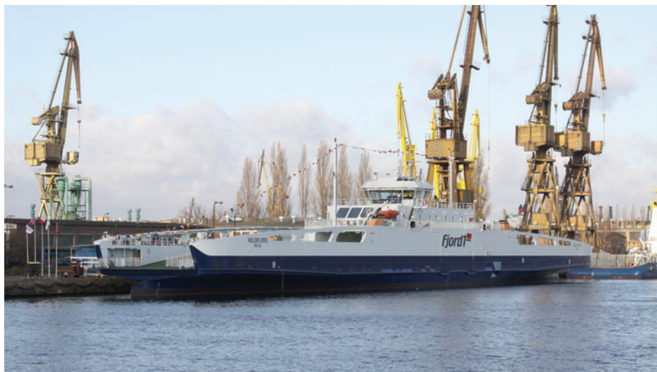
Moldefjord - statek o długości 122,70 m pomieścić może 390 pasażerów i 128 samochodów osobowych lub 12 zestawów drogowych (trailerów z ciągnikami) i 55 samochodów.
