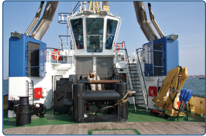
Rufowa wciągarka holownicza, hak holowniczy i składany żuraw pokładowy.
