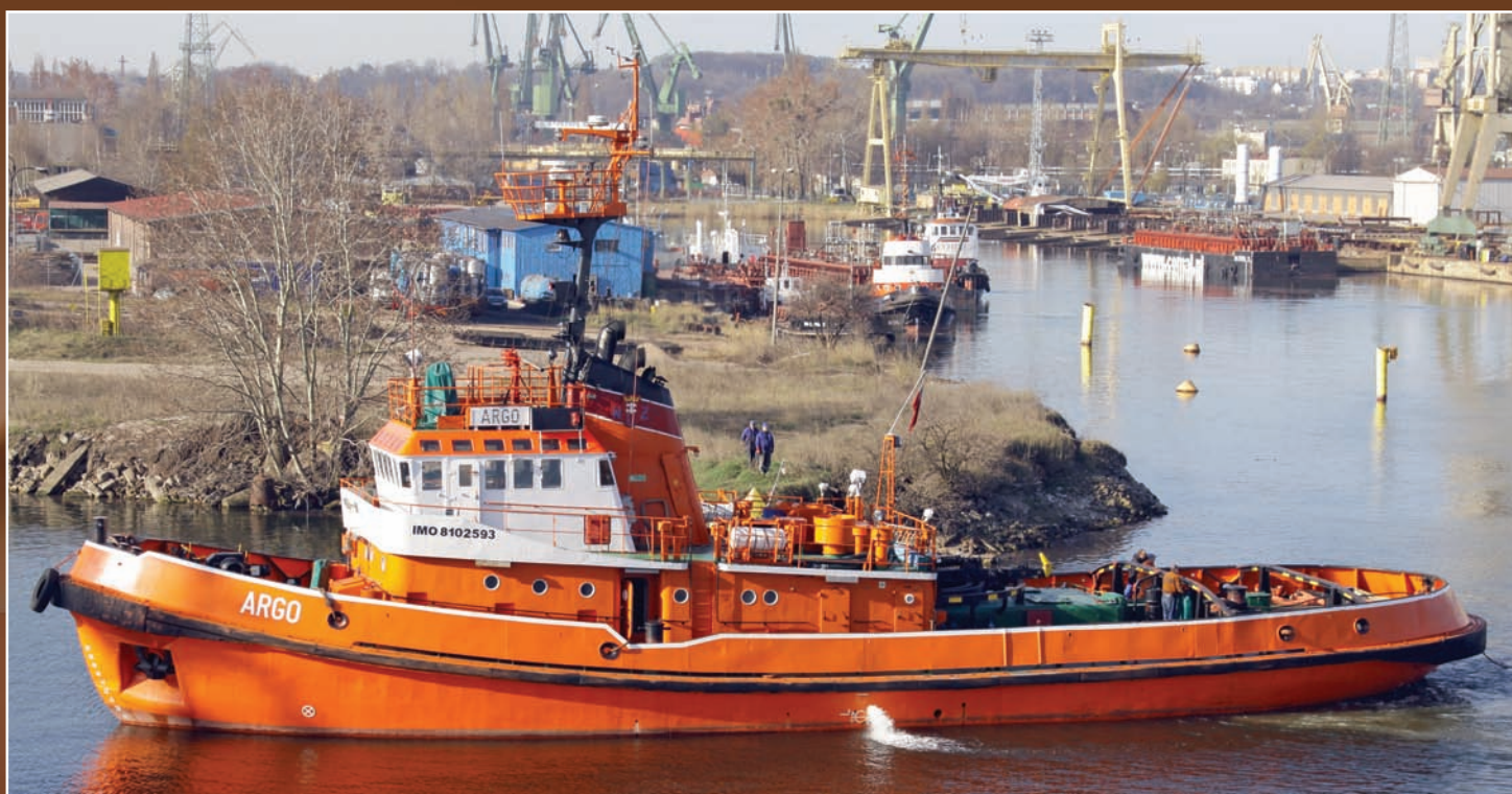
Argo (IMO 8702593, SQMC); prędkość maks. 14 węzłów, uciąg na palu 33,8 T; wyposażony w hak holowniczy 30 T i kabestan 5 T.
