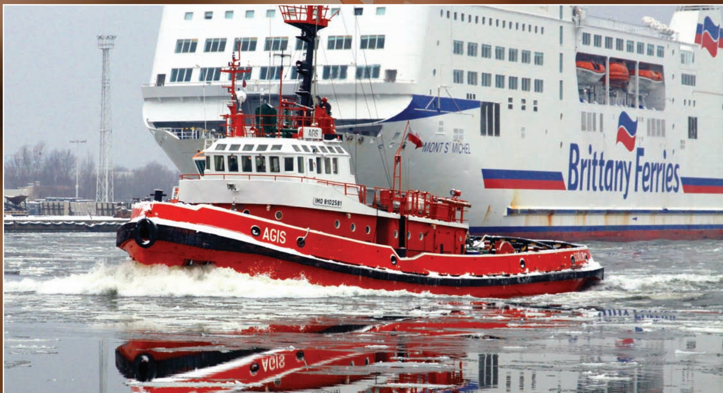
Agis (IMO 8102581, sygnał wywoławczy SQMB); prędkość maks. 12 węzłów, uciąg na palu 30 T; wyposażony we wciągarkę 25 T i hak holowniczy 30 T.
