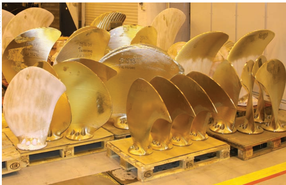
Płaty śrub sterów strumieniowych i pędników azymutalnych w zakładzie produkcyjnym w Ulsteinvik.
