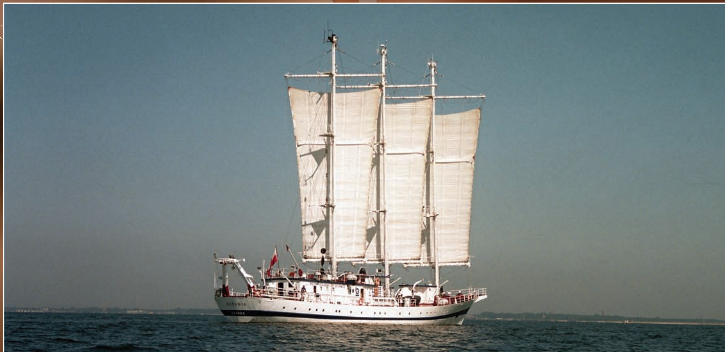
Żaglowiec ma 48,9 m długości, 9 m szerokości i 3,8 m zanurzenia. Wypiera 370 ton wody. Ma silnik o mocy 600 kW. Potrafi osiągnąć maksymalnie 15 węzłów. Na zdjęciu – przed przebudową.
