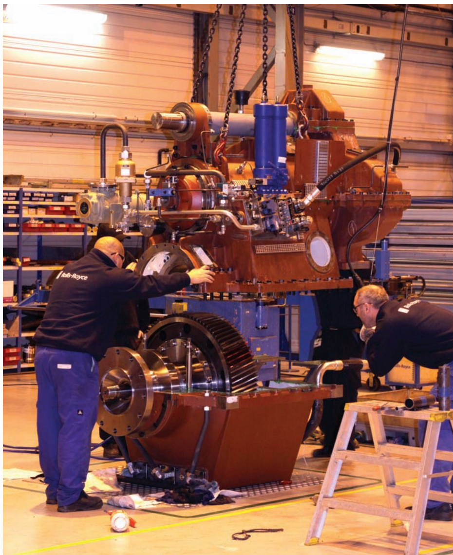
Montaż okrętowej przekładni redukcyjnej w zakładzie Rolls-Royce’a w Ulsteinvik.
