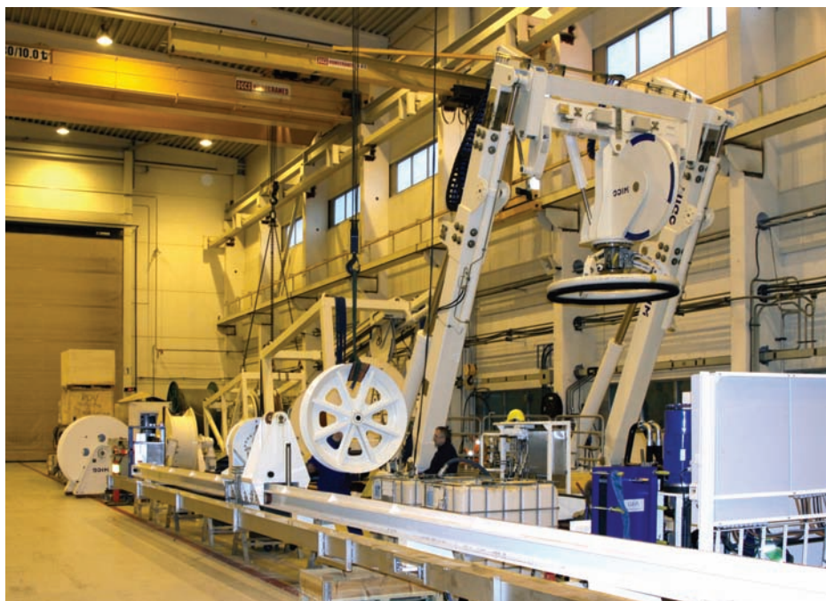
Żurawiki „A-frame”, a właściwie całe systemy LARS (launch and recovery system) do wodowania i podejmowania zdalnie kierowanych pojazdów podwodnych (inaczej - ROV-handling system) na linii montażowej w zakładzie Odim w Hareid.
