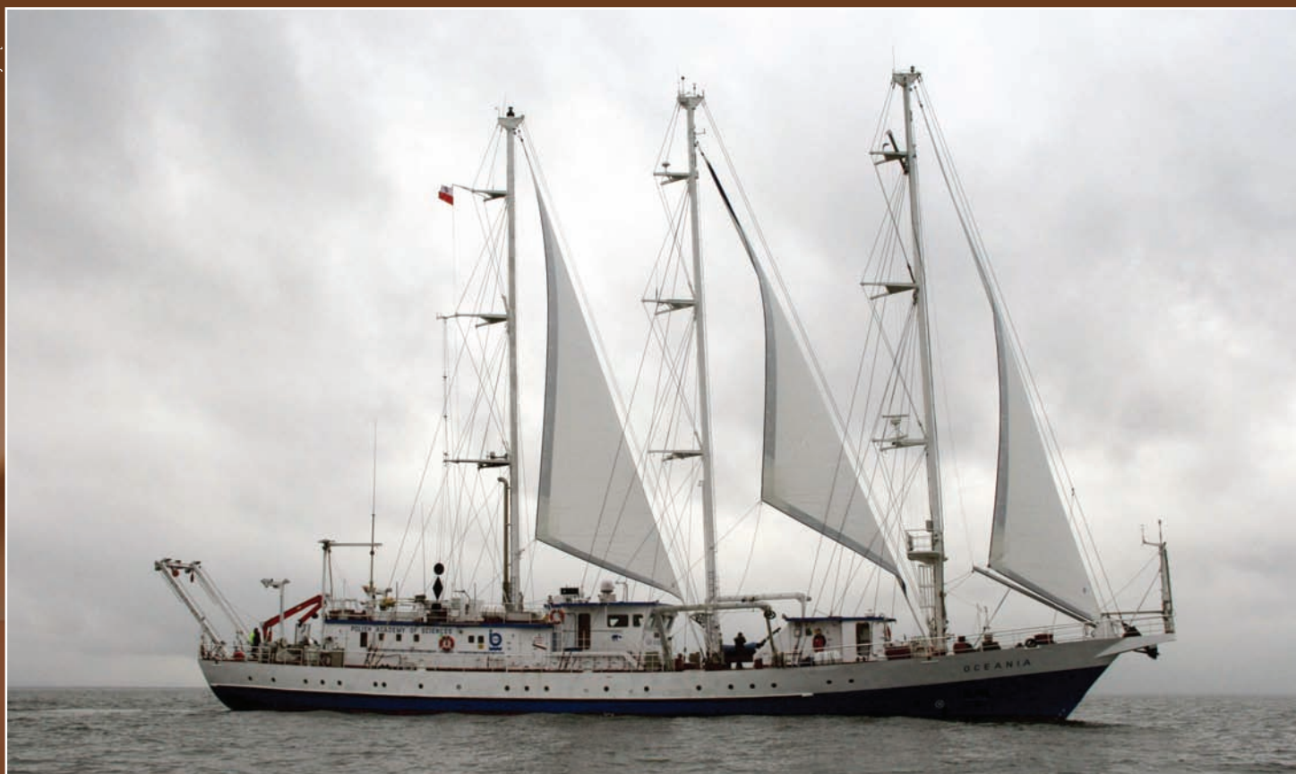
Po remoncie - w miejsce trapezowatego kształtu żagli rejowych, o łącznej powierzchni ponad 300 m 2 , trzy wielkie żagle sztaklowe rozpięte na trzech, wysokich na 32 metry masztach.
