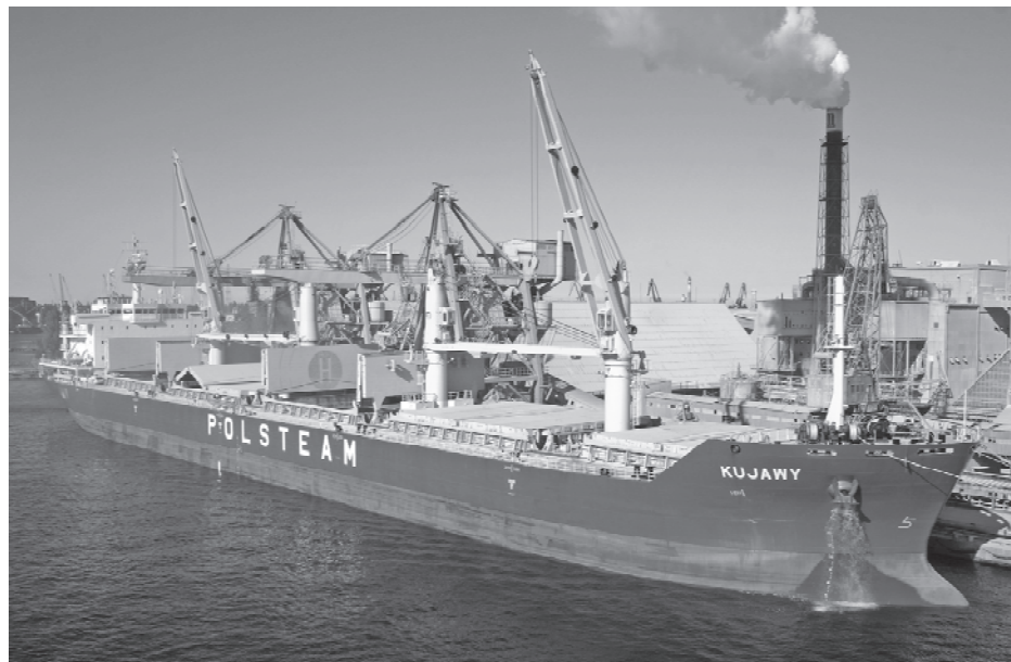
Kujawy - pierwszy ze statków zbudowanych dla PŻM w chińskiej stoczni Xingang w Tianjin. Powstały jeszcze trzy masowce z serii, każdy o nośności 38 tys. t. - Mazury, Podhale i Warmia. Zaczęły wchodzić do eksploatacji od początku 2005 roku.
