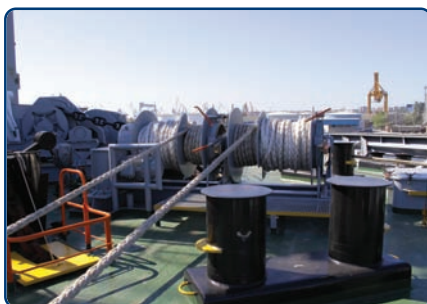
Na dziobie - pokład manewrowy z wciągarkami Rauma Brattvaag - cumowniczą i kombinowaną.
