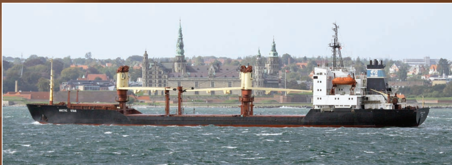
Arctic Star - należący do Solchart Group drewnowiec (klasyfikowany jako drobnicowiec, nr IMO 8603418, ex Tegra , zbudowany w 1991 roku w Stoczni Gdańskiej jako Akademik Glushko - ósma jednostka z serii B352), o nośności 7850 t i wyporności 11 249 t, przy zanurzeniu 7 m oraz długości 131,60 m i szerokości 19,30 m.
