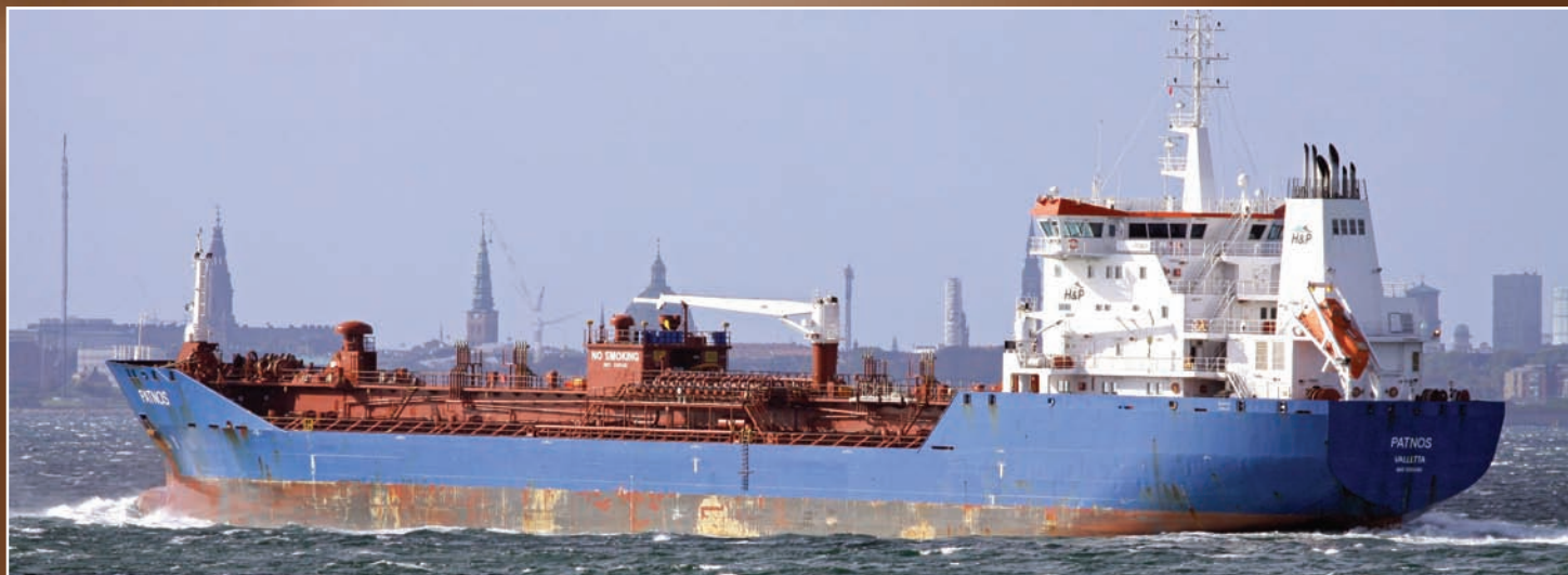
Patnos - chemikaliowiec-produktowiec (nr IMO 9365489, zbudowany w 2006 roku jako Marida Patnos w stoczni Qluxin Shipyard z Szanghaju), charakteryzujący się nośnością 16 714 t, wypornością 22 578 t, zanurzeniem 8,90 m, długością całkowitą 144,05 i szerokością 23 m. Statek, którego operatorem jest obecnie Brostrom Tankers Sweden AB, należy do niemieckiej firmy Tanker Schiffahrts GmbH i pozostaje w third party ship management u Haren & Partner Ship Mgmt, którego barwy nosi (wraz ze znakiem armatorskim na kominie).
