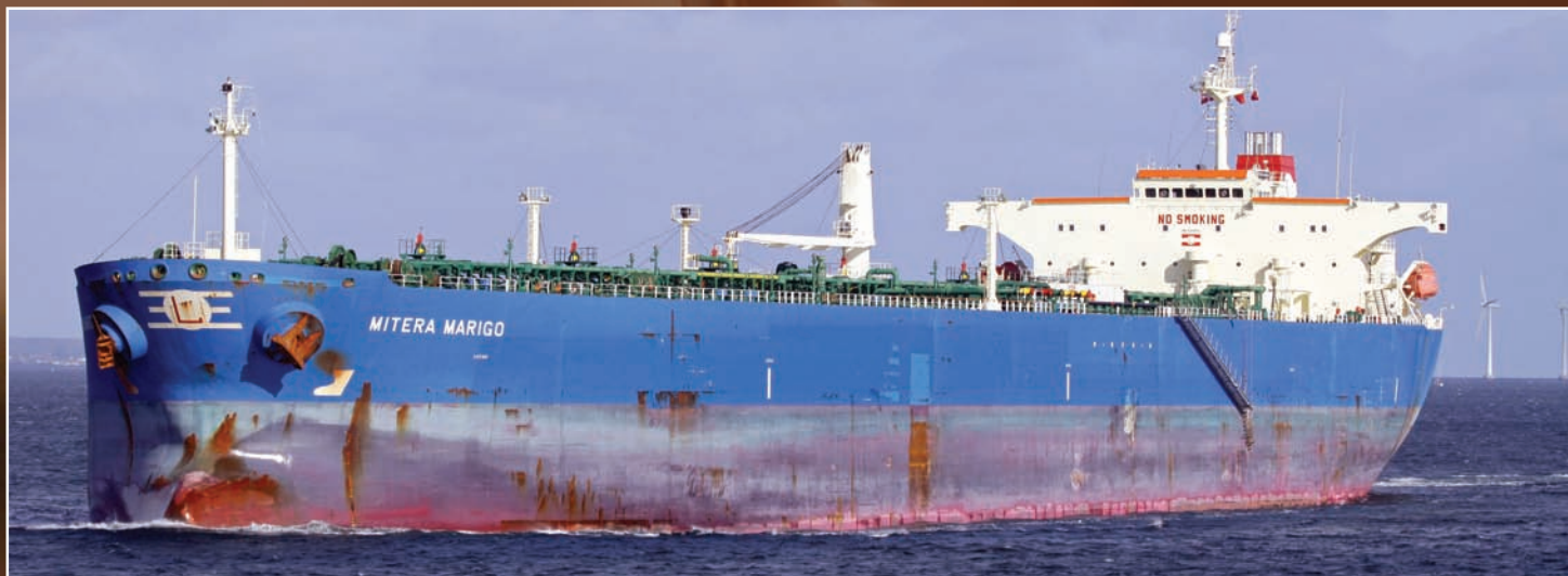
Mitera Marigo - zbiornikowiec naftowy i produktowiec (IMO 9321976, przekazany do eksploatacji przez japońską stocznnię Sumitomo Heavy Industries Marine & Engineering Co., Ltd. w Yokosuka na początku 2007 roku), o nośności 105 495 t, wyporności 121 473 t, długości 237,71 m, szerokości 42 m i zanurzeniu 14,878 m. Operatorem statku jest amerykańska firma Sigma Tankers Inc., a właścicielem - Atlas Maritime Holding Inc. z Grecji.
