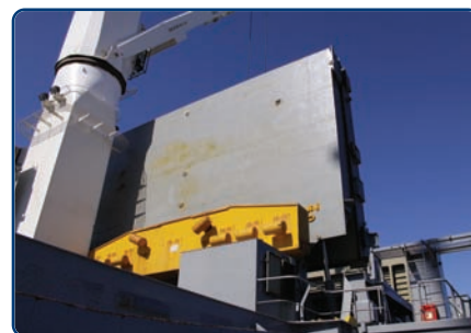
Żółte elementy zasztauowane na skraju pokładu dziobówki, między ładowniami nr 1 i 2, to jedne z będących na wyposażeniu statku trawersów do ładunków ciężkich.
