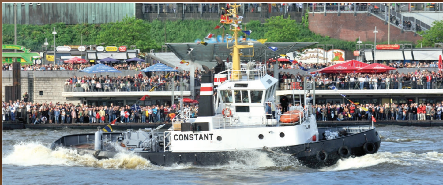
Constant – holownik, długi na 28 m, o mocy napędu głównego 2502 KM, zbudowany w 1987 roku przez zachodnio-berlińską stocznię Deutsche Industrie-Werke GmbH i eksploatowany przez armatora L & R - Lutgens & Reimers GmbH) podczas dynamicznego manewru wykonywanego w ramach „baletu holowników” w 2009 roku.
