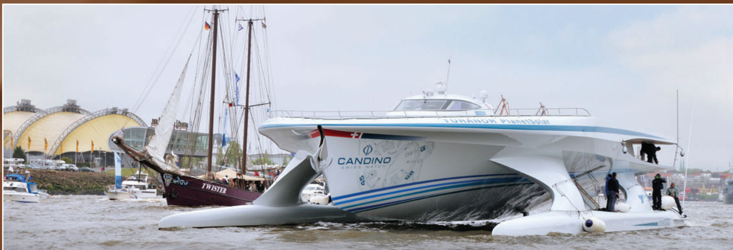
PlanetSolar - jeszcze jedna jednostka ze stoczni w Kilonii - tym razem jachtowej Knierim Yacht Club, ale z zupełnie innej epoki niż Sedov . To eksperymentalny katamaran - największa w świecie jednostka pływająca o napędzie „słonecznym” (wyposażona w ogniwa fotowoltaiczne). Podczas ostatniego Hafengeburtstag miała publiczną premierę, a w przyszłym roku ma się udać w podróż dookoła świata. W skrócie: długość 31 m, szerokość 15 m (35 m i 23 m w rozłożonych dodatkowych „skrzydłami” (panelami słonecznymi), maks. powierzchnia paneli fotowoltaicznych 536 m 2 , moc z ogniw 93,5 kW / 127 KM.
