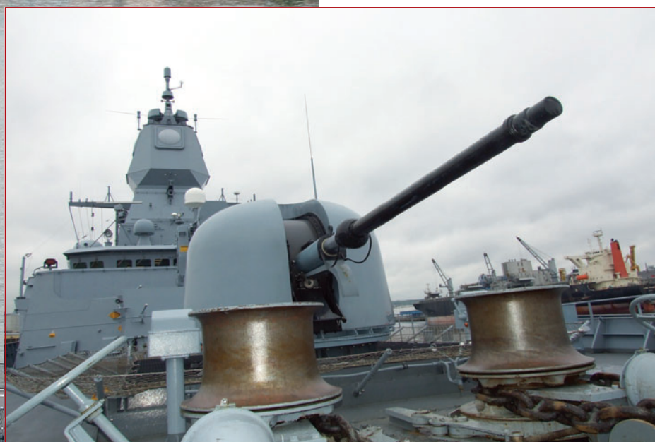
Działo kalibru 76 mm. Za nim APAR - radar sprzężony z systemem kierowania pociskami raketowymi.
