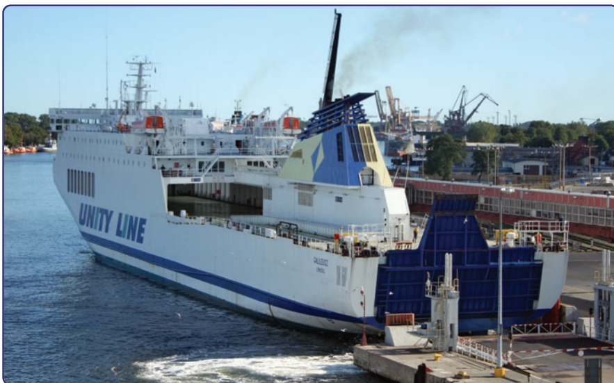
Zwraca uwagę rampa rufowa z przedłużeniem o szerokości jednego pasa ruchu, w ramach przystosowania do terminali, do których zawija prom Galileusz.
