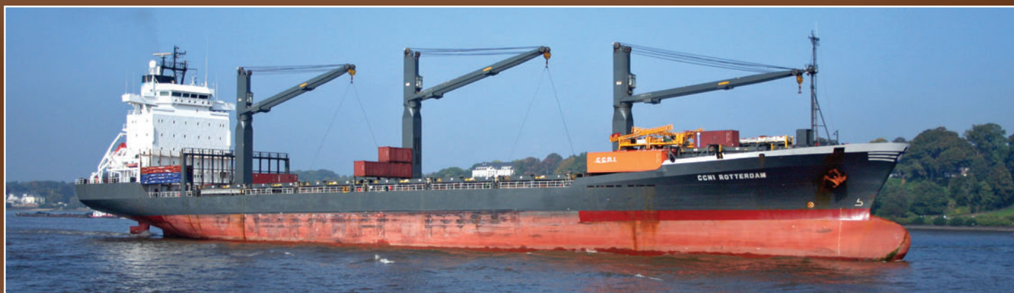
CCNI Rotterdam - pojemnikowiec udźwigwiony typoszeregu BV 1600, zbudowany w 1993 r. w stoczni Schichau Seebeckwerft AG - Bremerhaven; GT 16 282, wyporność 30 306 t, nośność 23 276 t, długość całkowita 164,05 m, ładowność 1684 TEU. Armator: MarConsult Schiffahrt, Niemcy; operator Chilena Interoceánica, Chile.
