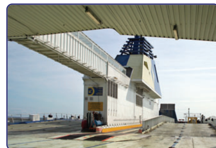
Ruchoma rampa (w pozycji roboczej) prowadząca z pokładu głównego na pokład górny wzdłuż wąskiego szybu maszynowego, po jego lewej stronie.
