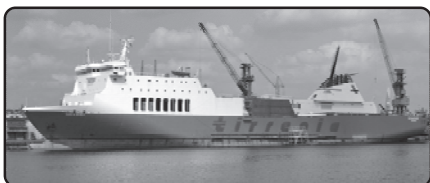
Galileusz w czasie przebudowy w szczecińskim porcie - widoczna niepomalowana jeszcze część nowej konstrukcji nadbudówki.
