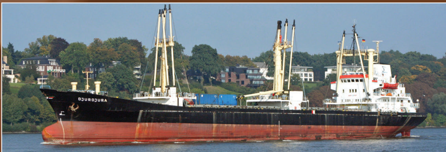
Djurdjura - klasyczny drobnicowiec, zbud. w stoczni Schlichting-Werft GmbH - Travemünde w 1977 r.; należący od zamówienia po dziś dzień do CNAN Group SpA z Algierji; GT 5389, nośność 8190 t, długość całkowita 126,45 m.
