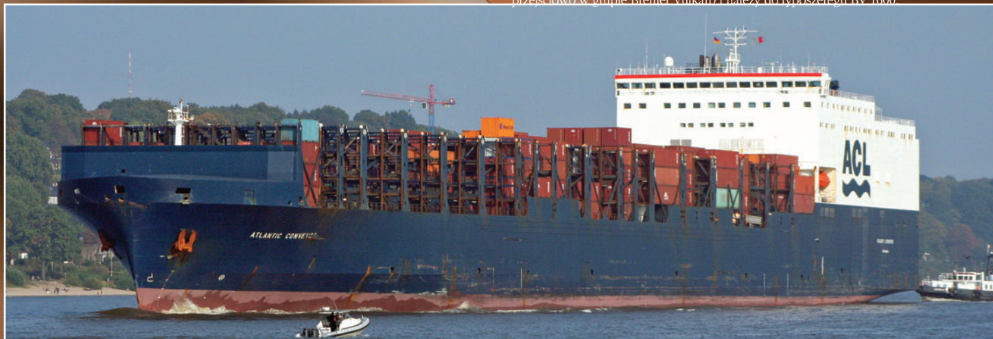
Atlantic Conveyor - statek typu con-ro, zbudowany w 1985 roku w stoczniach Swan Hunter Shipbuilders Ltd. i Wallsend-Neptune (przedłużony w 1987 r. w stoczni Scott Lithgow Ltd. - Greenock); GT 58 438, nośność 51 648 t, długość całkowita, 291,92 m, ładowność w części lo-lo: 424 TEU w ładowniach i 1000 TEU na pokładzie, ładowność w części ro-ro 1484 TEU, długość linii ładunkowej ro-ro 3372 m. Operatorem statku jest Atlantic Container Line AB, obecnie w grupie Grimaldi.
