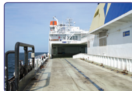
Widok z tylnej części pokładu górnego na szyb maszynowy z kominem i - w głębi - na nadbudówkę. Po lewej (przy burcie) widoczna stacja bunkrowa (przyłącza, armatura) osłonięta konstrukcją z rur ochraniającą przed ewentualnym uszkodzeniem przez manewrującą na pokładzie pojazdy.
