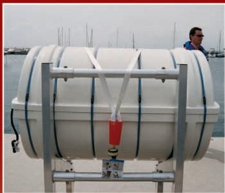
Kontener z tratwą Zodiac dla 150 osób czeka w gotowości na nadbrzeżu w jednym z basenów portu Roses.
