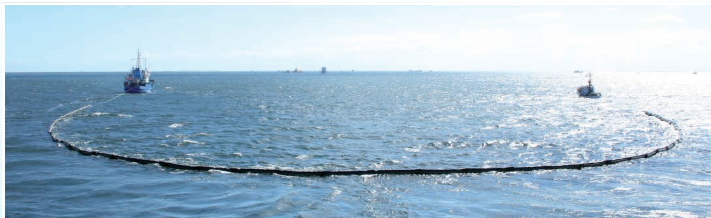
W trakcie ćwiczeń biorące w nich udział statki ciągnęły pływające zapory przeciw-rozlewowe...
