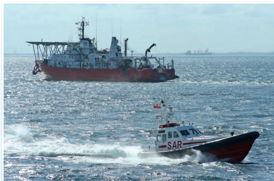
Statek badawczy i bazowiec prac podwodnych St. Barbara Petrobaltiku (na dalszym planie) podczas wysypywania na powierzchnię morza substancji symulującej rozlew ropy.
