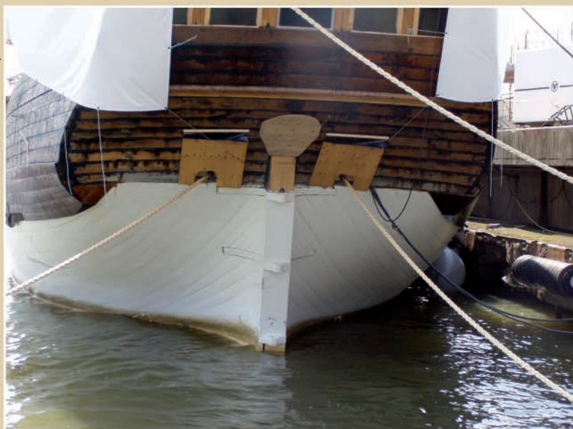
Rufowa część Göthenborga jeszcze przed zamontowaniem steru.
